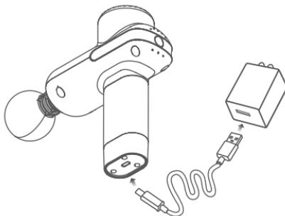
3 ACアダプターを壁面コンセントに差し込む。
